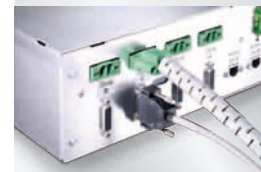
Generator Anschluss Spulen-I- fühlerkabel
