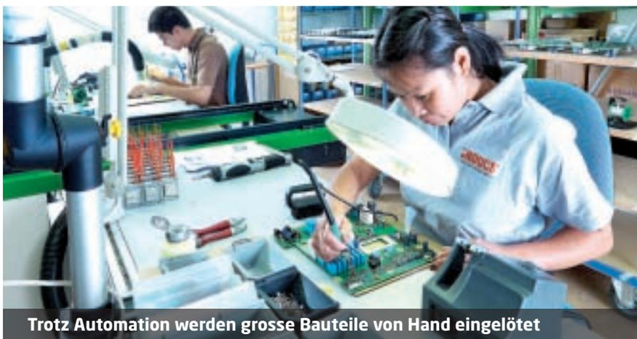
Trotz Automation werden grosse Bauteile von Hand eingelötet
