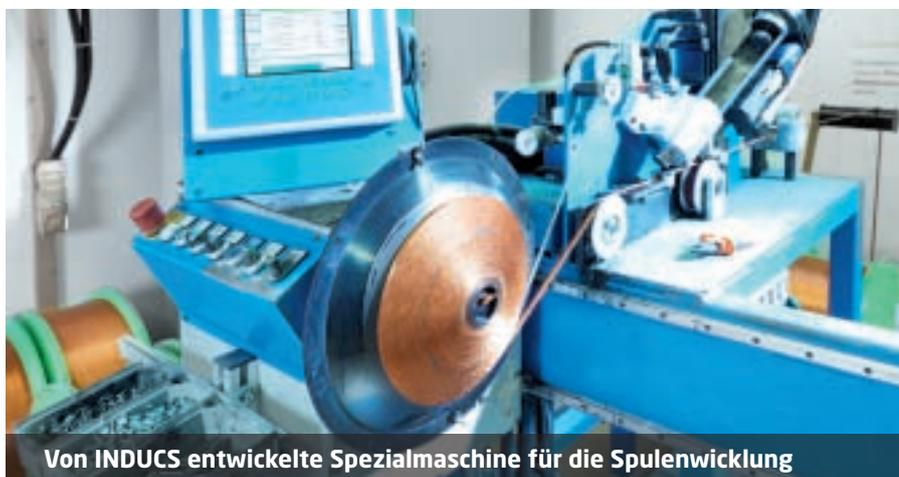
Von INDUCS entwickelte Spezialmaschine für die Spulnwicklung
